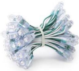
**Pixel LED 9mm 0,1W 5V
